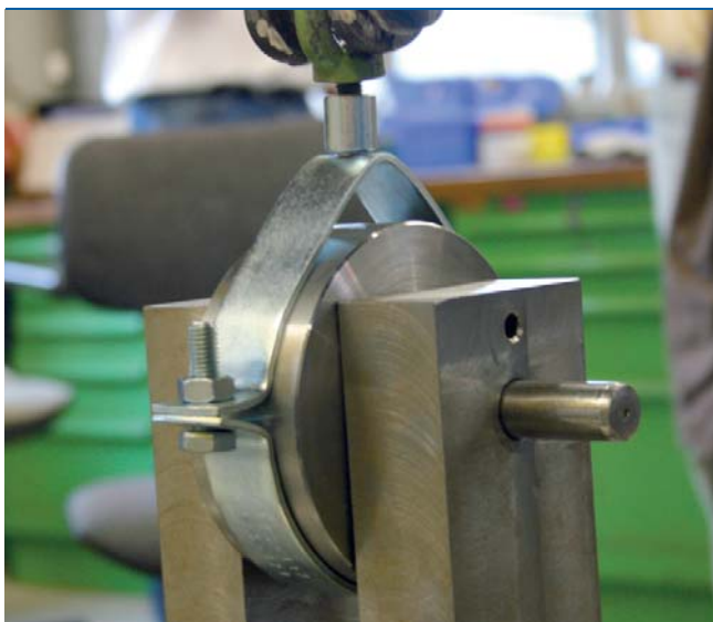
Prüfung einer Rohrschelle
